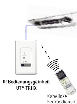
Kassetteneinheiten können mit kabelloser Fernbedienung gesteuert werden.
