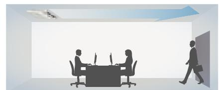
Im Heizmodus wird die warme Luft nach unten, Richtung Boden, gerichtet. Dadurch werden die Beine der, im Raum befindlichen, Personen gewärmt und der Kopf bleibt angenehm kühl.
