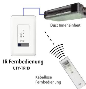
Zwischendecken-Modelle können mit kabelloser Fernbedienung gesteuert werden.
