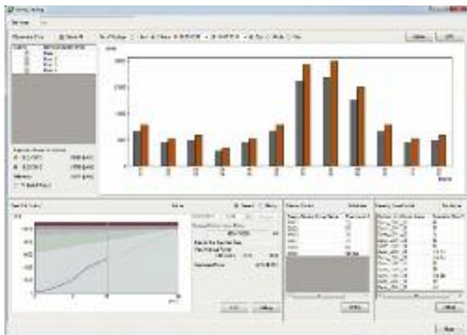
Dieses Diagramm vergleicht den Stromverbrauch mit dem Vormonat und dem Vorjahr, um die Analyse des Energiespareffekts zu vereinfachen.
