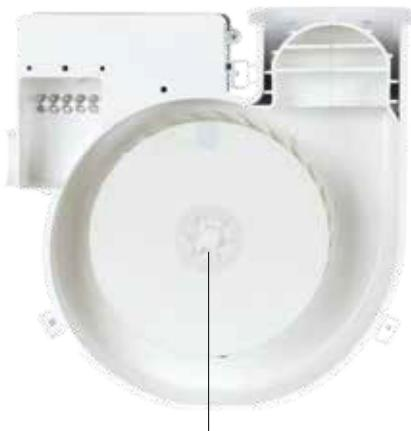
Lauftrad mit vorwärts gekrümmten Lamellen für besondere Laufruhe, zur besseren Beständigkeit gegen Reinigungsmittel aus PBT hergestellt. Der hohe Wirkungsgrad ist das Resultat von Erkenntnissen aus intensiven aerodynamischen Studien.
