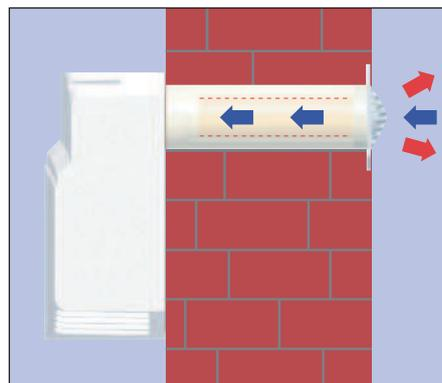
Rohr in Rohrtechnik
